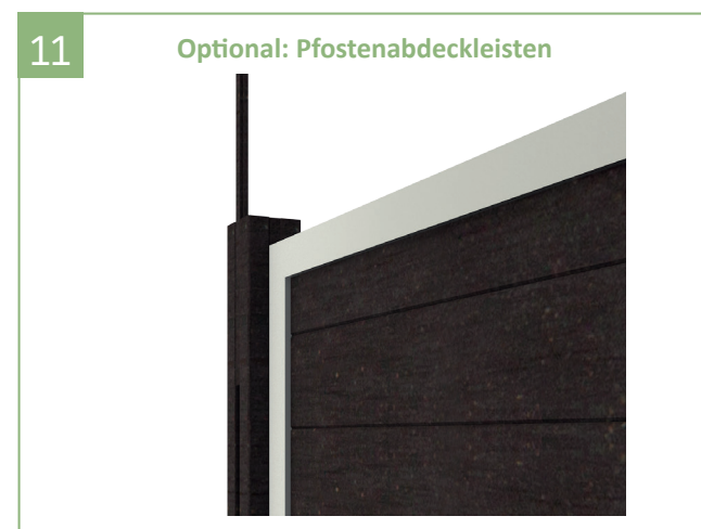
11 | Die Pfostenabdeckleisten von oben in die Pfostennut einschieben und mit der Unterkante des Pfostens bündig abschließen.
