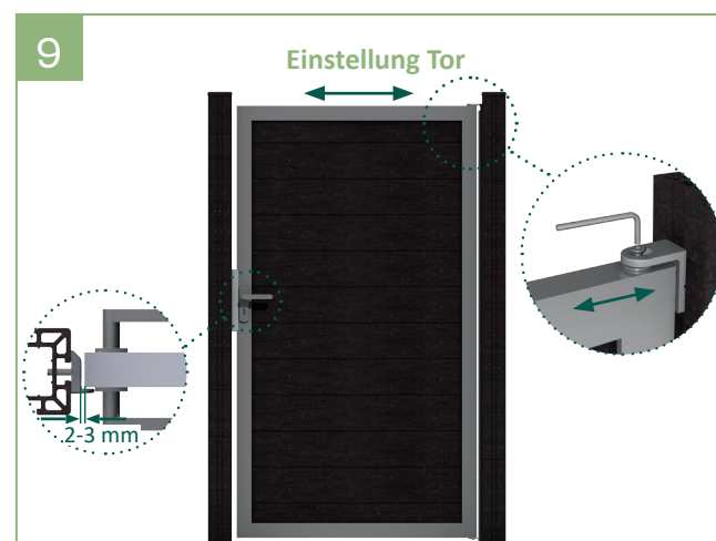
9 | Zur genauen Einstellung lässt sich das Tor durch die verstellbaren Torbänder in die gewünschte Position bringen.
