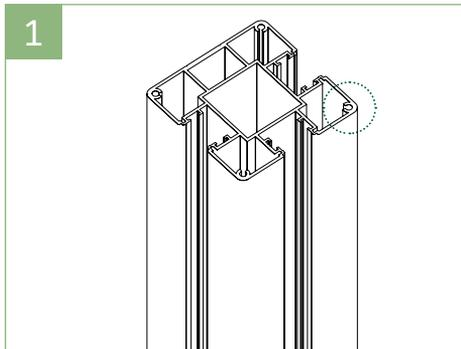
1. Der zur Konsole passende 7 x 7 cm Pfosten (GJ 48) oder 9 x 9 cm Pfosten (GJ 49) aus Aluminium ist mit 4 zusätzlichen Schraubkanälen zur Fixierung ausgestattet.
