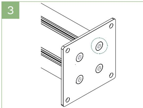
3. Die mitgelieferten Schrauben werden von unten durch die Konsole in die Schraubkanäle des Pfostens geschraubt und versenkt.
