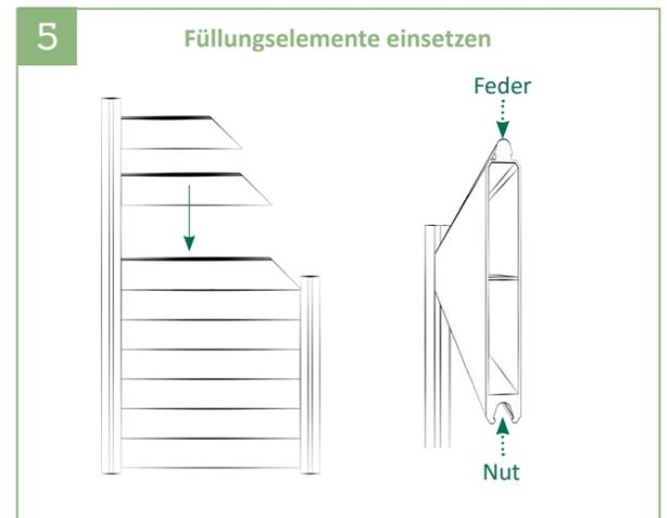
5 | Die Füllungselemente nacheinander von oben einschieben, dabei die Feder der Füllungselemente nach oben ausrichten.
