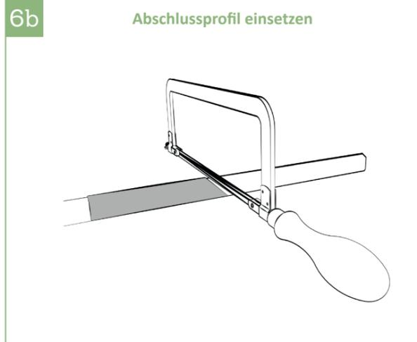
6b | Markieren Sie mit Hilfe der mitgelieferten Schablone den Gehrungsschnitt. Sägen Sie das Abschlussprofil mit einer Metallsäge passend zu und setzen Sie diese anschließend auf das Zaunelement. Optional kann das Abschlussprofil mit zwei Schrauben fixiert werden.
