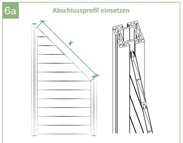
6a | Messen Sie die oben angegebene Länge. Bitte messen Sie immer von der Innenkante bis zur Innenkante des Pfostens!
