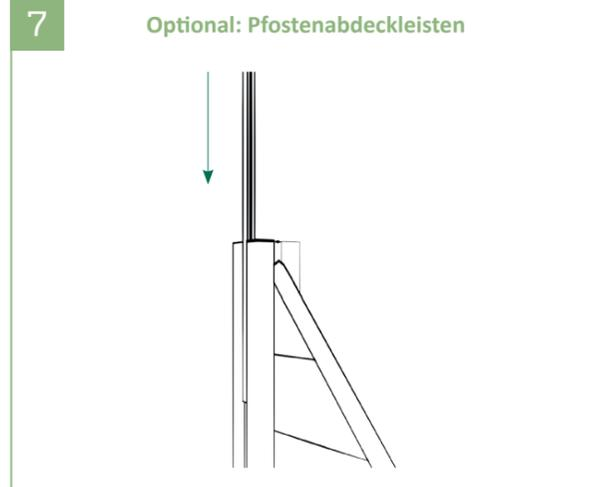
7 | Die Pfostenabdeckleisten von oben in die Pfostenut einschieben und mit der Unterkante des Pfostens bündig abschließen.
