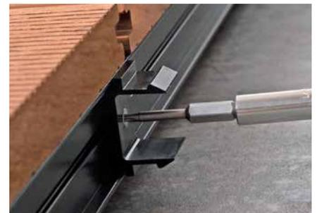
Für die Montage der Frontblenden werden die Blendenclips seitlich an die Alu-UK geschraubt. Die Blenden werden dann einfach eingeklickt.
