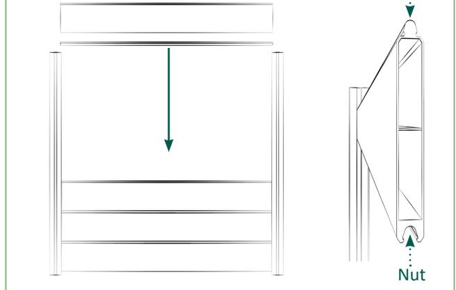
5a | Bei GroJaSolid Grande **Premium** werden zusätzlich Lisenen zwischen die Füllungelemente nacheinander von oben eingeschoben. Hierbei ebenfalls die Nut- und Federausrichtung berücksichtigen.
