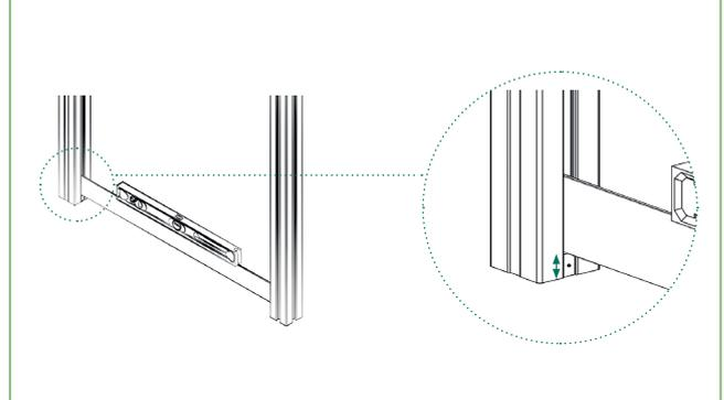
4 | Zuerst auf einer Seite das Distanzstück befestigen. Das Distanzstück der zweiten Seite mit Hilfe eines Füllungelementes und einer Wasserwaage ausrichten und befestigen.
