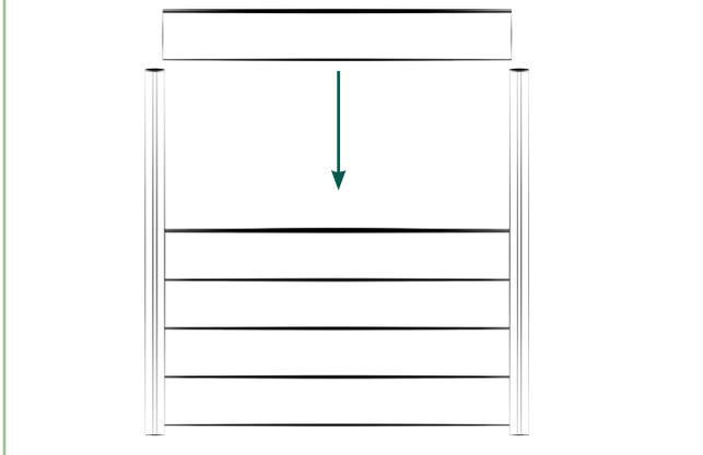
5 | Bei GroJaSolid Grande **Standard** die Füllungelemente nacheinander von oben einschieben, dabei die Feder der Füllungelemente nach oben ausrichten.
