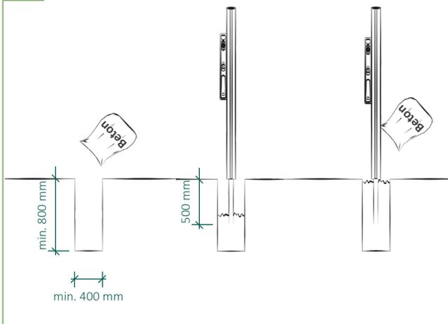
1 | Größe der Fundamente mindestens 400 x 400 x 800 mm sowie unter Berücksichtigung der Bodenbeschaffenheit.\* Ungefähr die Hälfte des Erdloches mit Beton füllen und verdichten. Anschließend die Pfosten setzen und ausrichten. Das Erdloch komplett mit Beton füllen und verdichten.
