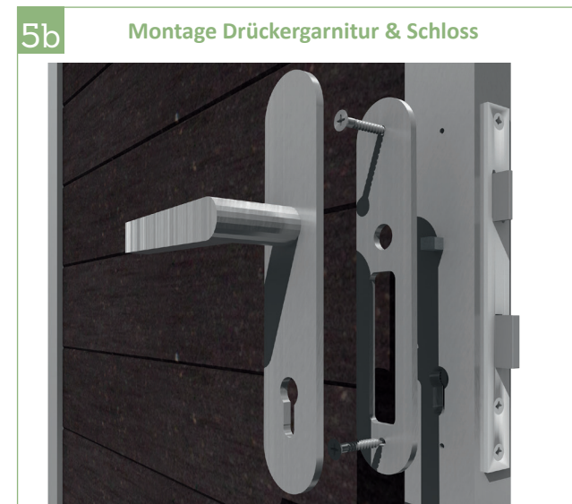
5b | Türdrücker innen einsetzen und anschrauben. Anschließend mit dem Türschild abdecken.
