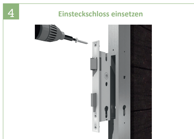
4 | Das Einsteckschloss einsetzen und dessen Position ausrichten, sodass der Schließzylinder und der Griff hineinpassen. Anschließend mit den beigelegten Schrauben befestigen.
