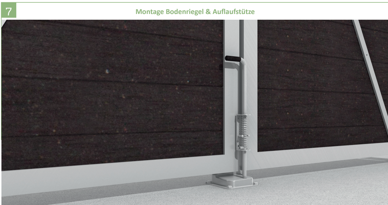
7 | Die Auflaufstütze mit vier Sechskantschrauben auf einen festen Untergrund (Betonsockel) verschrauben. Den Bodenriegel passend zur Auflaufstütze montieren.
