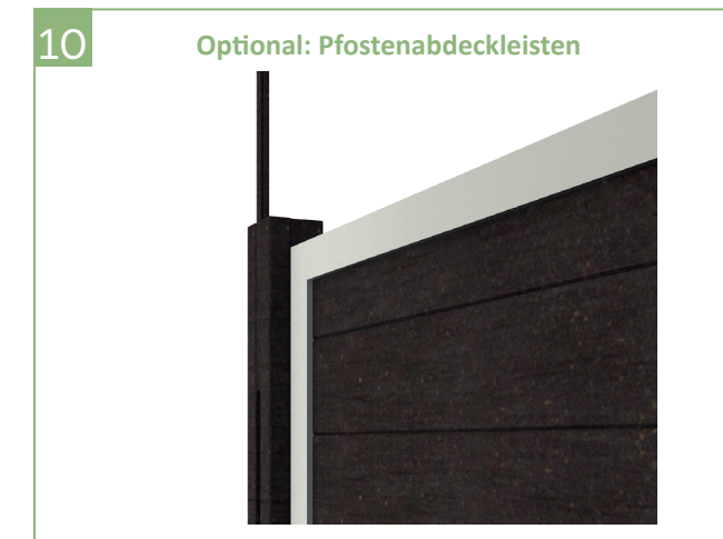
10 | Die Pfostenabdeckleisten von oben in die Pfostennut einschieben und mit der Unterkante des Pfostens bündig abschließen.
