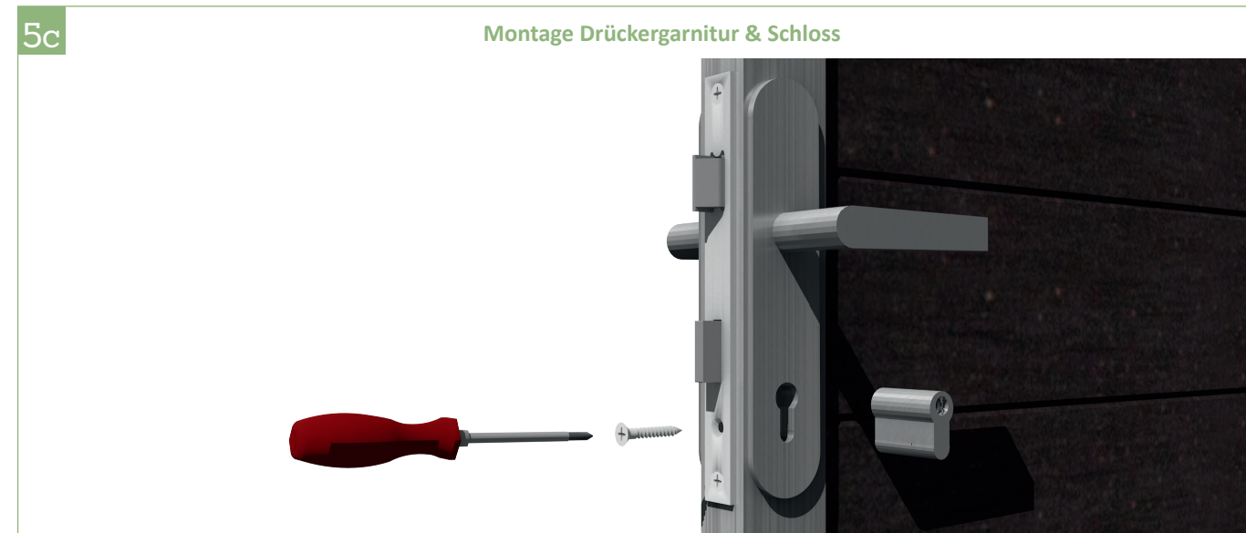
5c | Zylinderschloss einsetzen und die Schraube mit dem Schraubendreher PH2 andrehen.
