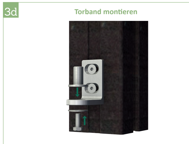
3d | Den unteren Lagerzapfen mit der Sechskantschraube und der Unterlegscheibe an die äußere Position des unteren Torbands schrauben.
